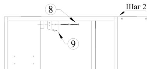
Установить в верхние углы кухонные навесы (9), закрепить их при помощи саморезов 4x30 (8)
