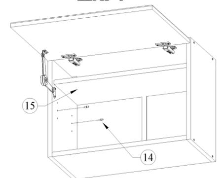
Вставить полкодержатели (14) в отверстия боковых стенок, установить полки (15)
