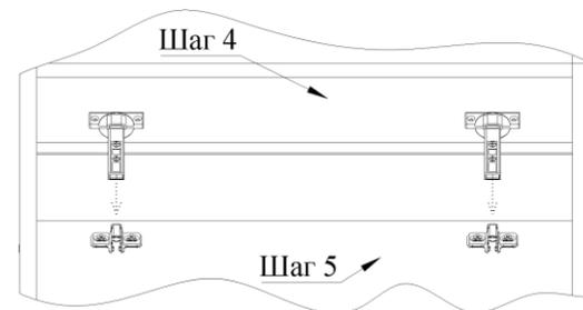
Верхнюю часть тела петли с креплением быстрого монтажа вставить в пазы ответной планки, зафиксировать нажатием сверху (по необходимости отрегулировать крепежным винтом).
