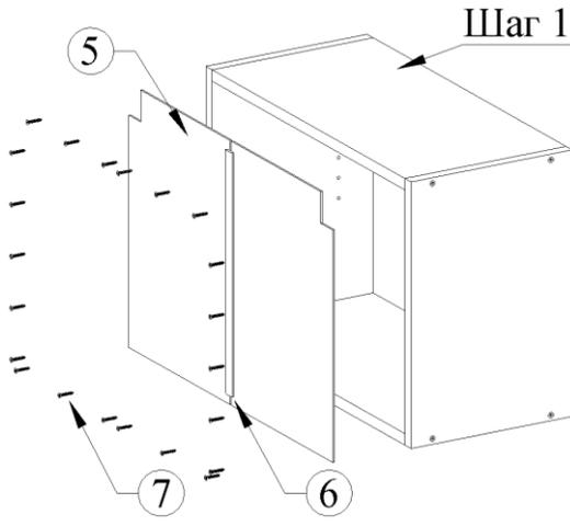
Соединить задние стенки (5) с помощью соединительной планки (6), затем притянуть их к корпусу шкафа (шаг 1) саморезами 4x16 (7)
