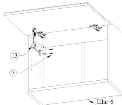
Прикрутить саморезами 4x16 (7) мебельный кронштейн (13) к боковой стенке шкафа и фасаду в соответствии с инструкцией, входящей в комплект кронштейна
