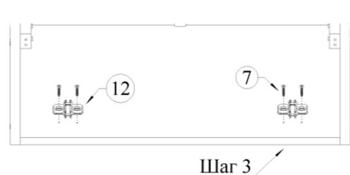
Прикрутить ответные планки (12) петель при помощи саморезов 4x16 (7) в размеченные+ под них отверстия в боковых стенках шкафа
